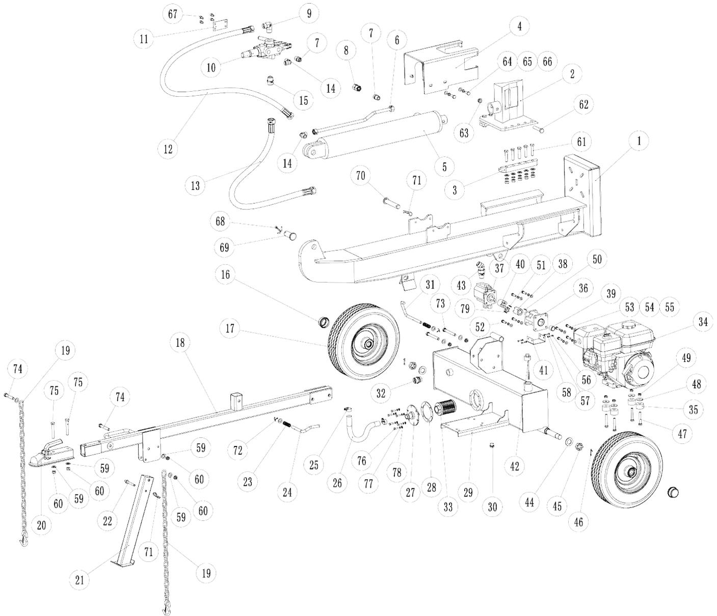
**Pièces de rechange pour fendeuse à bois hydraulique PG25T**
