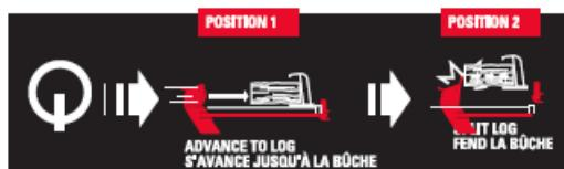
La force et la vitesse de fendage sont contrôlées par le levier de commande à 2 niveaux.
