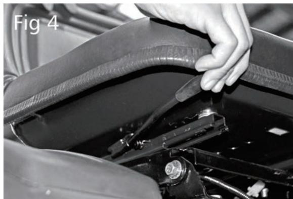
2. Pousser le levier de réglage du siège (B sur la figure 3) vers l'extérieur (direction C sur la figure 3).
