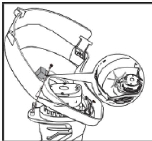
Fixez la partie arrière de la protection de sécurité à la tête de coupe jusqu'à ce que le loquet s'enclenche.
