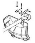
Montez la plaque de serrage supérieure (B) sur l'arbre de sortie.
