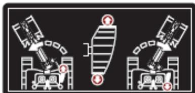
Appuyez sur l'avant de la pédale pour faire pivoter la flèche vers la gauche. Appuyez sur l'arrière de la pédale pour faire pivoter la flèche vers la droite.
