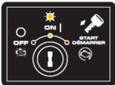
INTERRUPTEUR MARCHE/ARRÊT/DÉMARRAGE DU MOTEUR L'interrupteur du moteur a trois positions. OFF - le moteur ne démarre pas ou ne fonctionne pas. ON - le moteur fonctionnera. Démarrage - le moteur s'allumera
