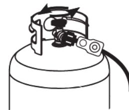
Figure 8 : Tourner le sélecteur de carburant sur la position PROPANE Soupape du réservoir de propane - OUVERTE
