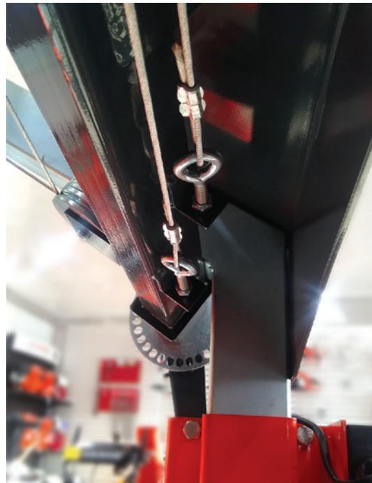
Ajoutez de la graisse imperméable sur le filetage de la poignée en "T" de la tension de la lame et sur la face de la rondelle avant son utilisation. Une tension correcte de la lame est obtenue lorsqu'une douille de 24 mm est utilisée sur une clé dynamométrique pour serrer la poignée en «T» à un couple de 17 Nm (12,5 livres pied, 150 livres pouces). Voir images ci-dessous.
