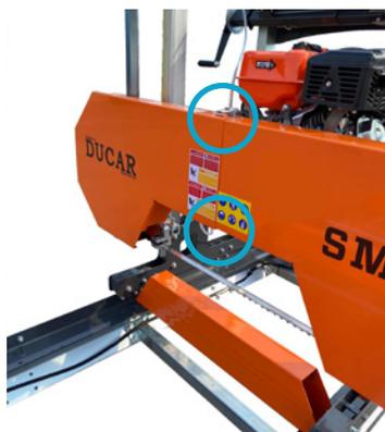
Poussez la tête de la scie vers l'avant et l'arrière du système de rails pour vous assurer que la largeur de la rail permet à la tête de scie de bouger librement. Si elle se coince ou semble serrée, l'espacement des roues du chariot peut être ajusté à nouveau en ajoutant ou en retirant des rondelles.
