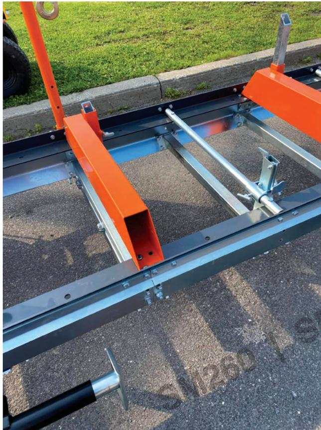
Insérez les supports de bûches dans les supports transversaux de rail et fixez-les avec les poignées en «T», comme indiqué dans l'image ci-dessous. Le filetage de la poignée en «T» doit être enduit de graisse.
